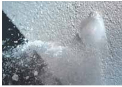
Aufnahme Hochgeschwindigkeitskamera – das WDV5 hält dem Hagelschauer stand.
