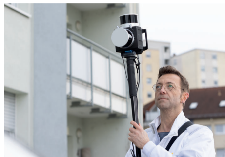
Acquisizione di facciate esistenti con scanner.
