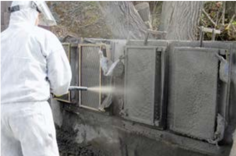
Herstellung von Prüfkörpern mit Anode (ibac Aachen)
