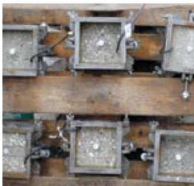
Prüfkörper zur Ermittlung des Elektrolytwiderstandes
