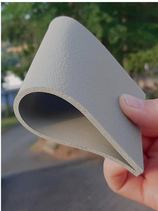
Für Arbeitssicherheit während der Reinigungs- und Wartungsarbeiten sorgt die Rutschhemmung der für Wartungszwecke begehbaren Oberfläche.
