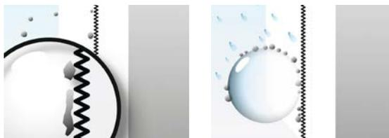
**Funktion 1:** Lotusan® hat eine mikrostrukturierte Oberfläche. Die Kontaktfläche für Schmutzpartikel und Wasser ist dadurch extrem reduziert.
