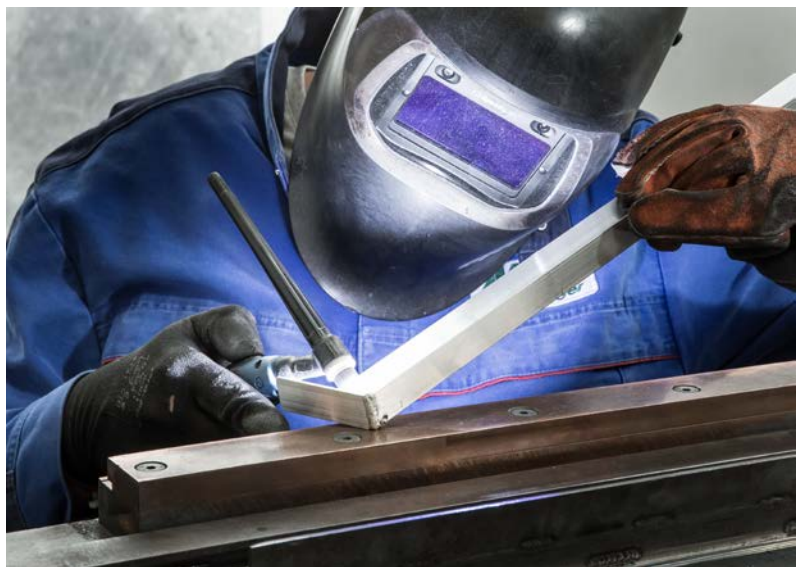
Bild unten: Verschweißung der Bordprofil-Oberteile, die aus stranggepressten Aluminiumprofilen gefertigt werden
