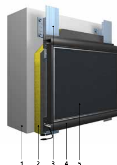
Systemopbygning StoVentec ARTline Inlay
