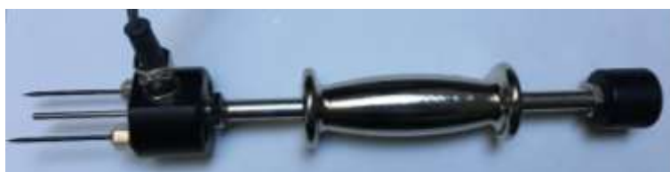
Figure 42 - Exemple d'humidimètre à pointe
