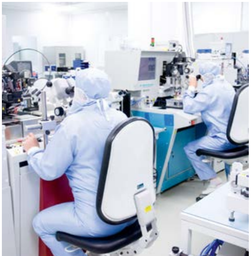
Bild oben: Böden für Sauberräume müssen auch bei Beanspruchungen durch z. B. Bürostühle oder sogar Hubwagen hoch abriebfest und mechanisch beständig sein. Foto: sebastianreuter/Adobe Stock
