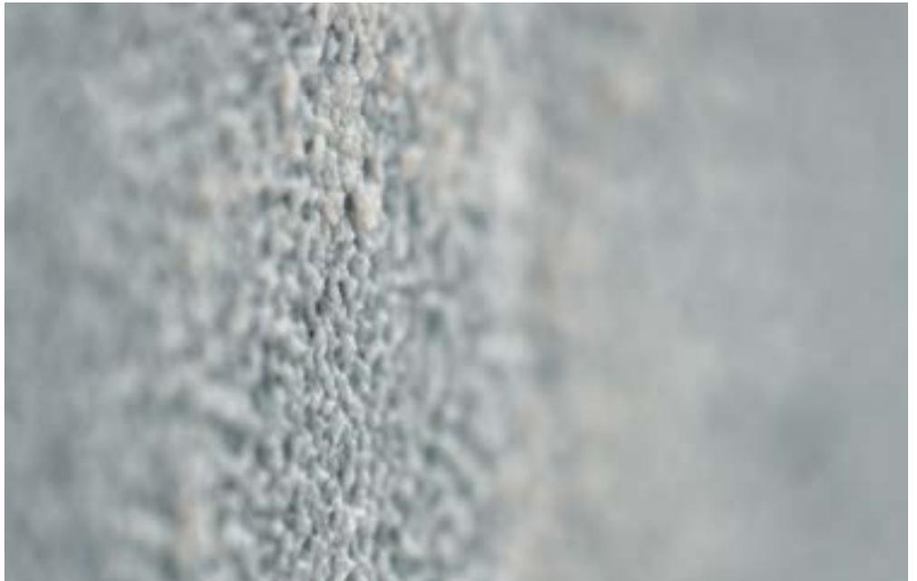
Anders als eine herkömmliche hydrophobierende Imprägnierung blockiert StoCryl HG 200 das kapillare Saugvermögen der porösen Betonrandzone vollständig. Ermöglicht wird dies durch die hohe Eindringtiefe des Wirkstoffs von circa sechs Millimetern. Die Betonrandzone bleibt wasserdampfdurchlässig. Der technische Aufwand bei der Ausführung der Tiefenhydrophobierung ist überschaubar.
